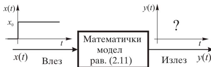
Слика 3.17. Блок-дијаграм за модел на возило
