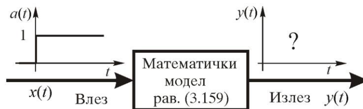
Слика 3.22. Блок-дијаграм на механички мерач на забрзување
