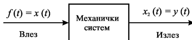
Слика 2.12. Блок-дијаграм на механичкиот систем
