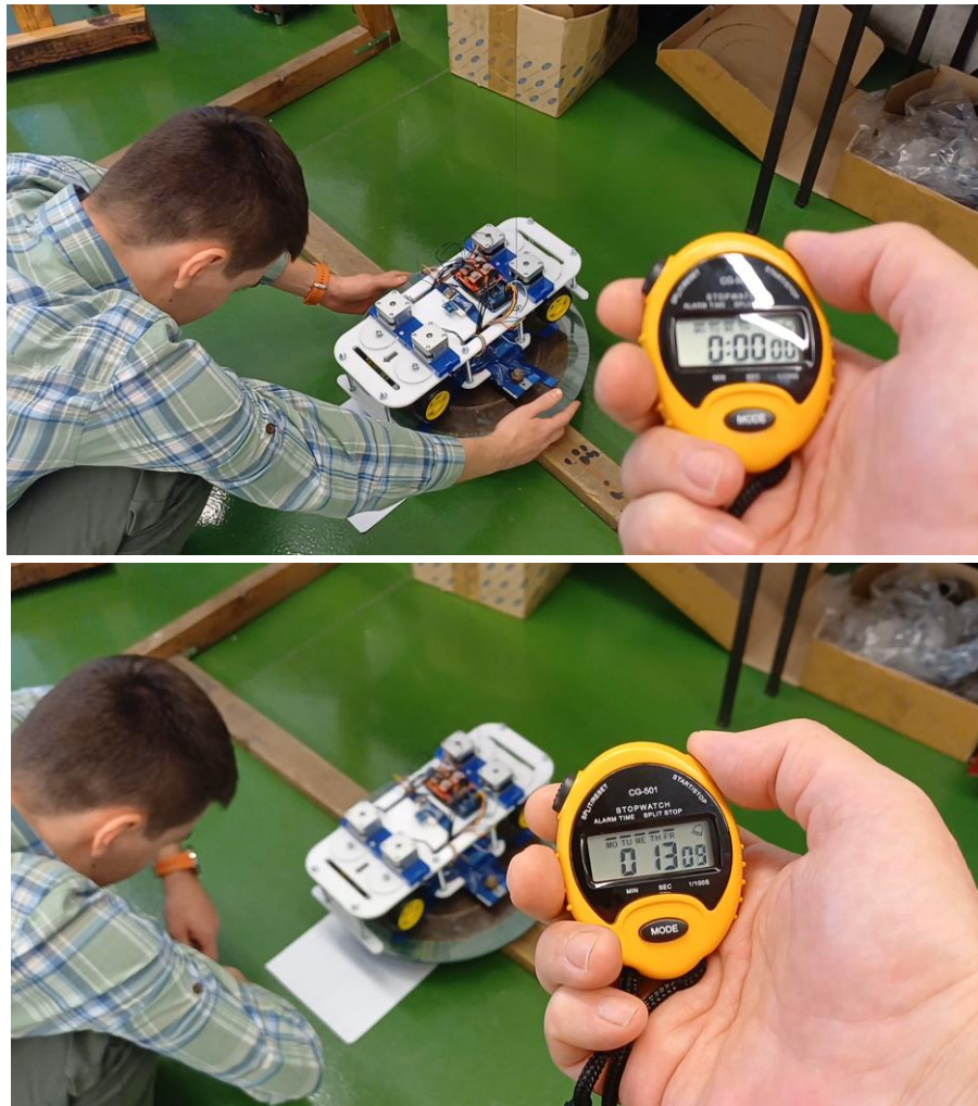
Слика бр. 5.11 Мерење на вкупниот материјален момент на инерција на системот диск-скалирано возило
