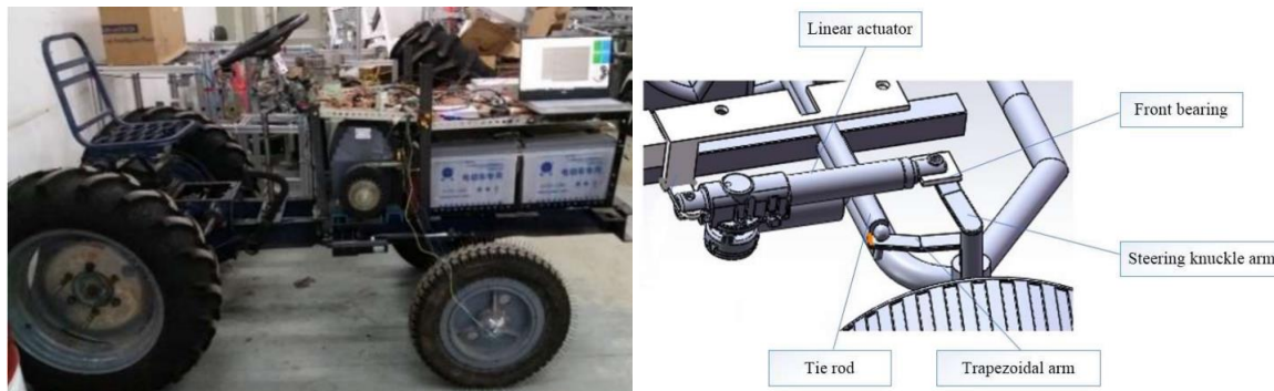
Слика бр. 2.17 Електричен трактор со вграден систем за управување преку сигнали (Li et al., 2019)
