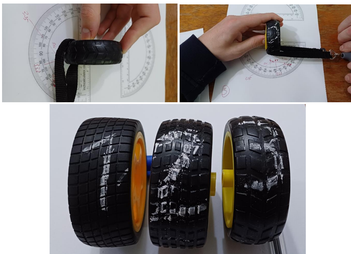
Слика бр. 5.13 Мерење на крутоста на пневматиците
