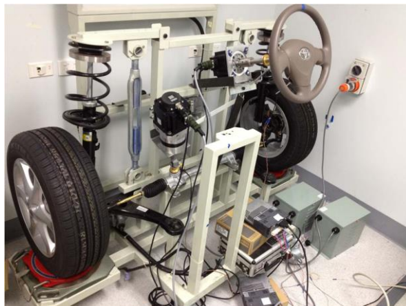
Слика бр. 2.19 Платформа за тестирање на систем за управување преку сигнали (Wang et al., 2013)
