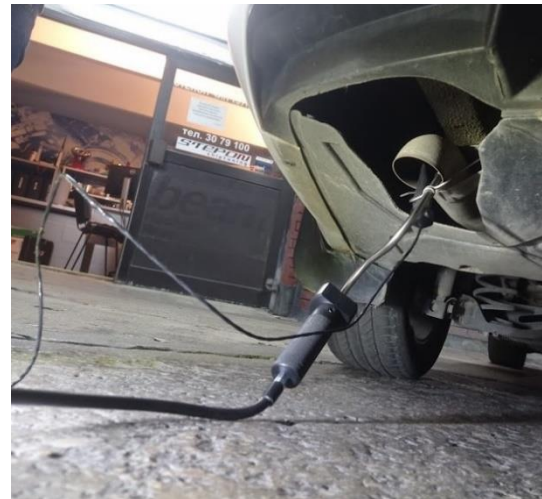
Слика 7-3 Поставеност на сензорската сонда во ауспухот на возилото
