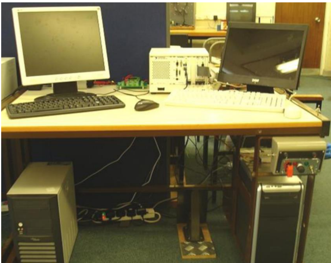
Слика 3-8 Хардверските компоненти на НИЛ алатката за изучување на процесот на калибрација на моторите на Универзитет во Брадфорд [68]
