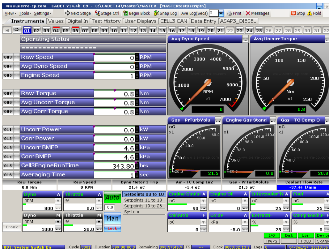
Слика 1-4 Основен работен прозорец – софтвер за управување со лабораториската тест-келија CADET (Sierra CP)
