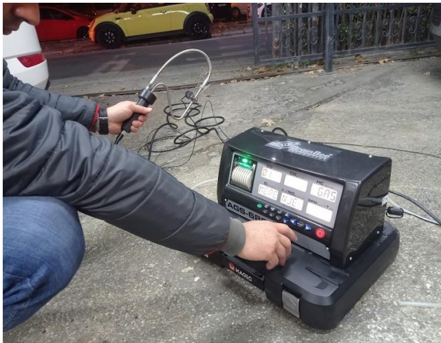
Слика 7-2 Калибрација на уредот за гасна анализа BrainBee AGS 688
