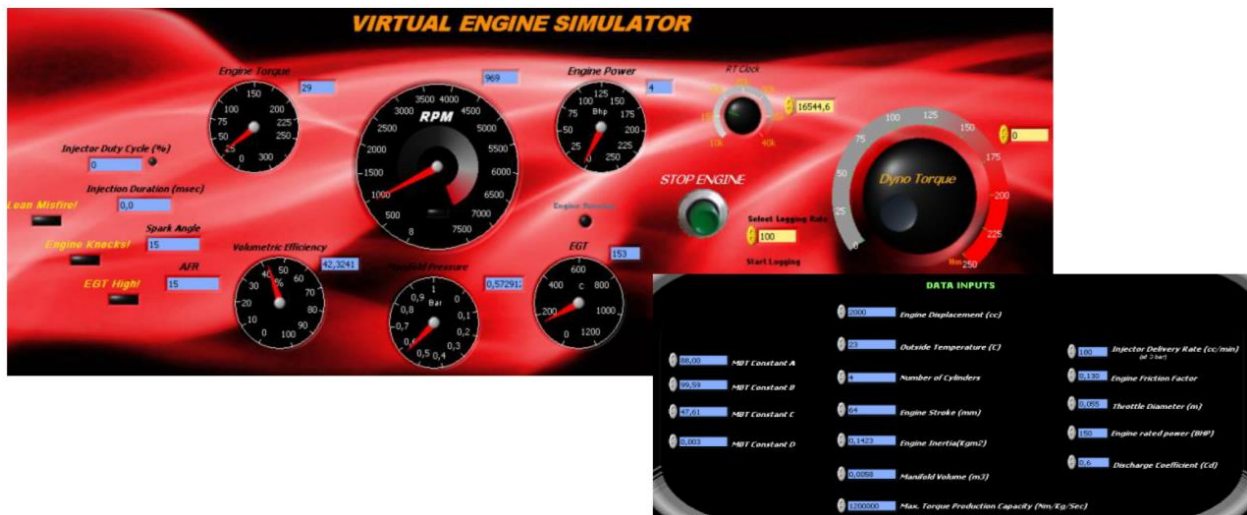
Слика 3-9 Корисничкиот интерфејс на HIL алатката за изучување на процесот на калибрација на моторите на Универзитет во Брадфорд [68]
