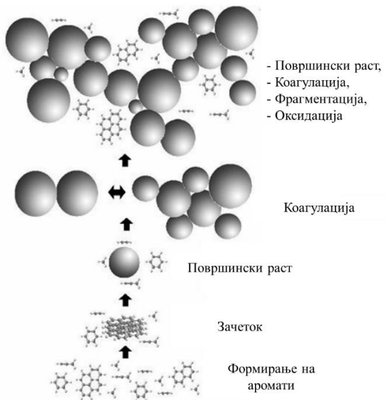
Слика 3-4 Хемискиот механизам на создавање РМ честички при согорување во моторот [47]
