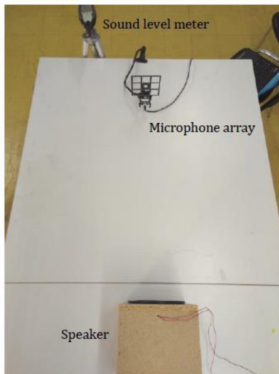
Слика 5. Тестирање на сензорската единица во лабораториски услови
