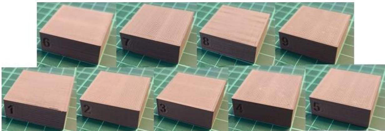
Слика 4.17. Добиеени „Зелени примероци“ по печатењето на Ultrafuse 316L Stainless Steel.
