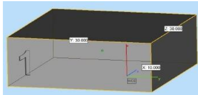
Слика 4.20. Димензии на 3D STL-моделот.
