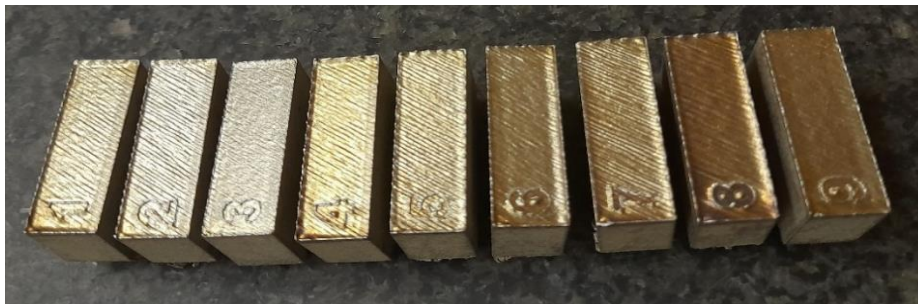
Слика 4.24. Отпечатени примероци со технологијата DMLS.
