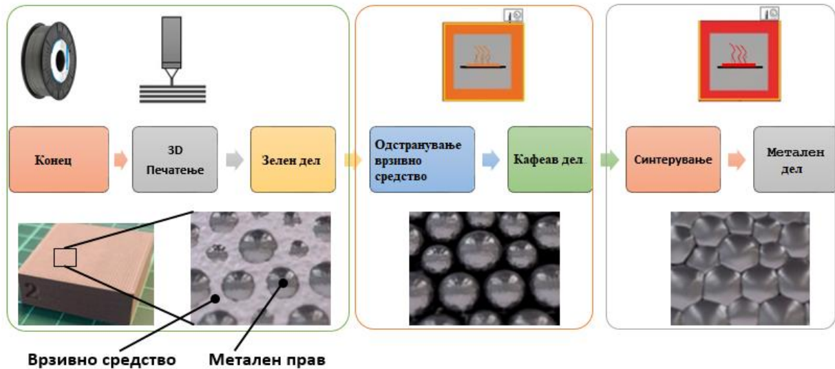
Слика 5.22. Шематски приказ на процесот на Material Extrusion Additive Manufacturing [168]
