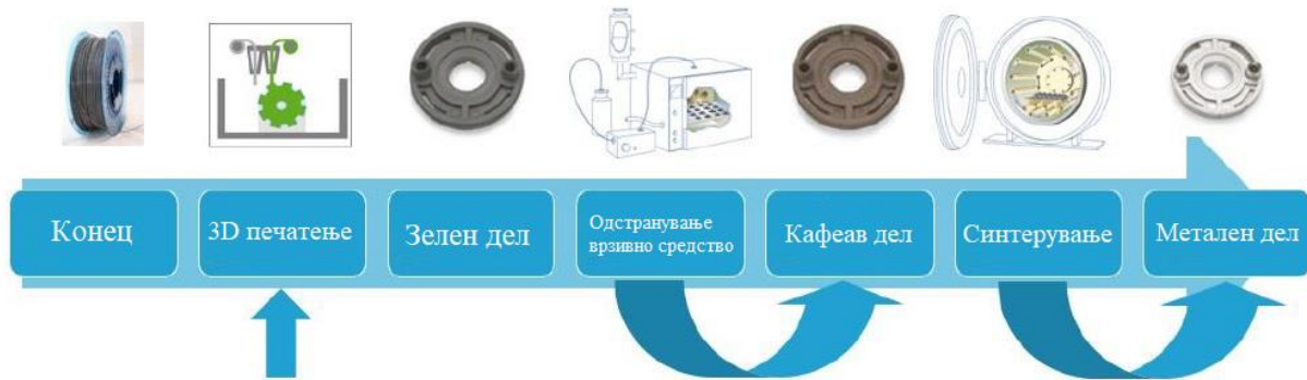
Слика 4.19. Процес на добивање на дел со технологија FFF.
