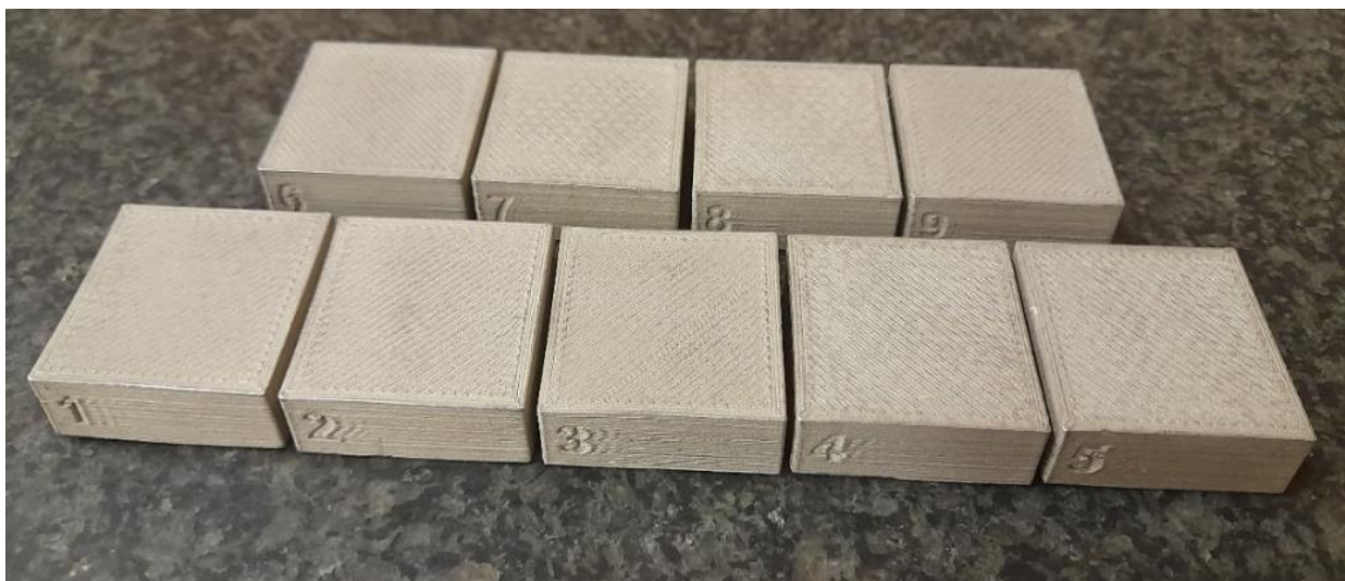
Слика 4.18. Приказ на готов примерок на 3D-печатен Ultrafuse 316L Stainless Steel со технологија FFF.
