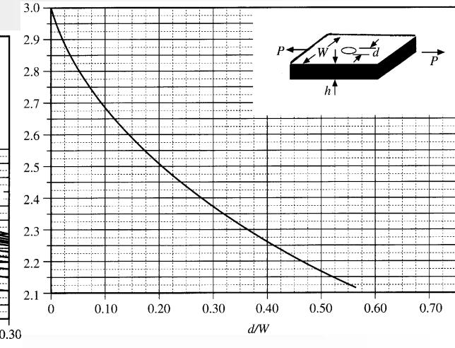
Дијаграми за коефициентот на концентрација на напони  $\alpha_k$  (вертикална оска) за различни облици при оптоварување од истегнување
