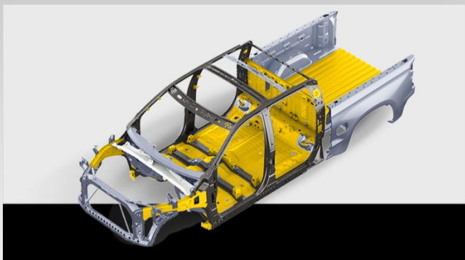
Комбинирана рамка-школка конструкција на возило
