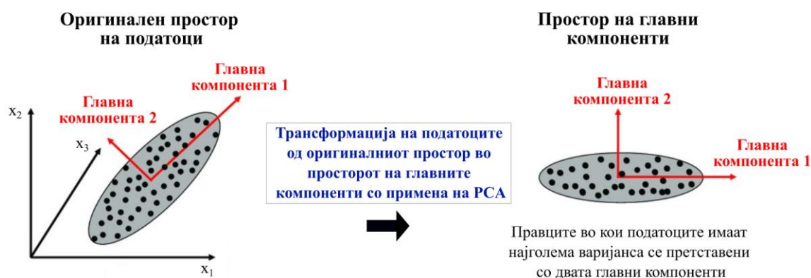
Слика 3.17: Шематски приказ на принципот на работа на алгоритмот анализа на главни компоненти
