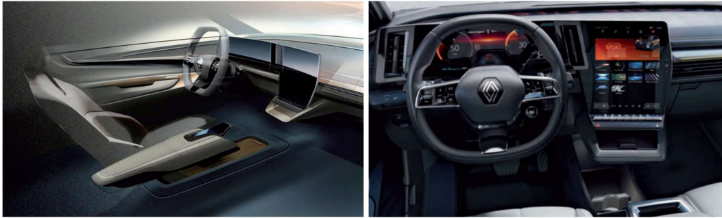
Слика 3-14. „Renault Mégane E-Tech Electric“ инфо-забавен систем со два 12.3" и 12" дисплеи позиционирани во форма на превртена буква „L“ (извор: Peter Sigal, A&D, 2022)
