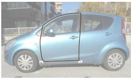
Слика 3-7. Контурата на отворот на вратата на модел на возило оценета како најудобна за влез/излез во истражување со 9 мали градски возила (извор: Angeleska et al. 2019)
