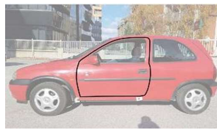
Слика 3-8. Контурата на отворот на вратата на модел на возило оценета како најмалку удобна за влез/излез во истражување со 9 мали градски возила (извор: Angeleska et al. 2019)
