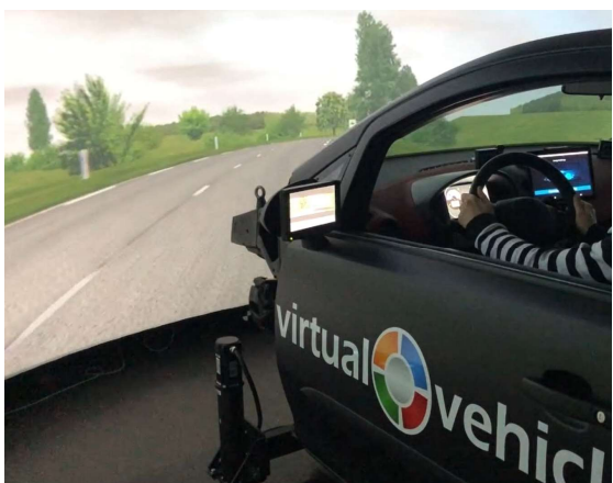
Слика 6-29. Симулатор за возење во „Virtual Vehicle GmbH“
