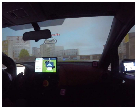
Слика 6-30. Таблет во кабината на симулаторот за прикажување на корисничкиот интерфејс
