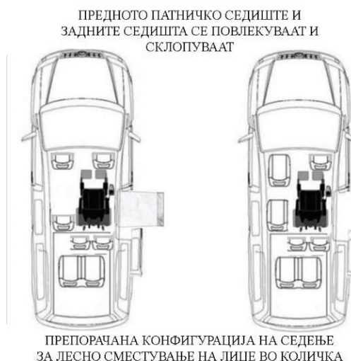
Слика 3-45. Можни позиции на седење во инклузивно АВ за сместување на лица во количка (извор: Allu et al. 2017)
