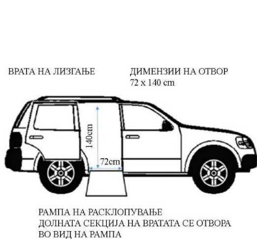
Слика 3-44. Карактеристики што треба да ги има инклузивното АВ за лесно влегување: широк отвор на вратата, спуштен под и рампа на преклопување (извор: Allu et al. 2017)
