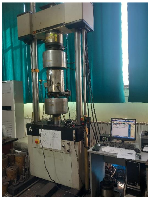
Слика 5.12 Комора за испитување со краткотрајно оптоварување на високи температури
