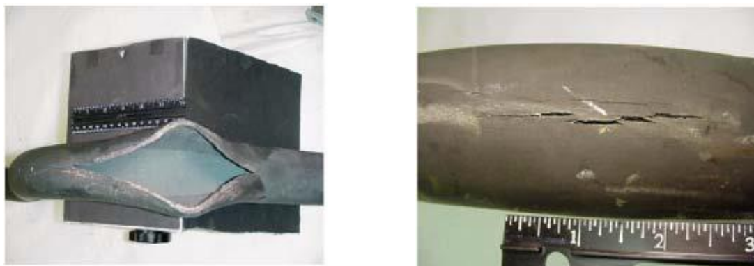
Слика 2.2 Пукнатина на цевка од прегревач на пара изработена од X10CrMoVNb9-1 како резултат на несоодветна термичка обработка, [50]
