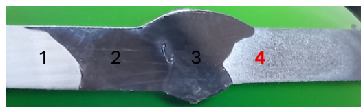
а) Разнороден заварен спој (1- ОМ 1 , 2 - обложен слој, 3 - завар, 4 - ОМ 2 )
