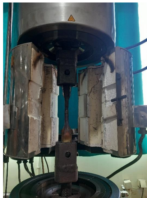
Слика 5.12 Комора за испитување со краткотрајно оптоварување на високи температури
