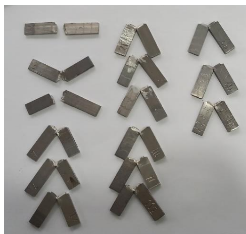
Слика 5.16 Уред и епрувети за испитување на жилавост и лом на епрувети
