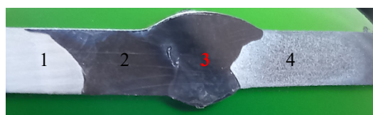
а) Разнороден заварен спој (1- OM_1 , 2 - обложен слој, 3 - завар, 4 - OM_2 )
