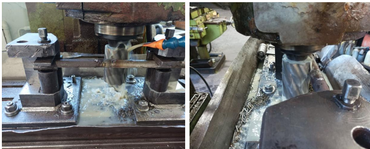
Слика 5.8 Изработка на спрувети од заварените проби
