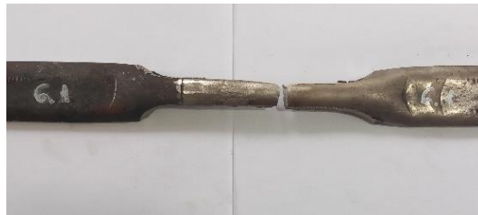
Слика 5.10 Епрувети и лом на епрувети при испитување на затегнување
