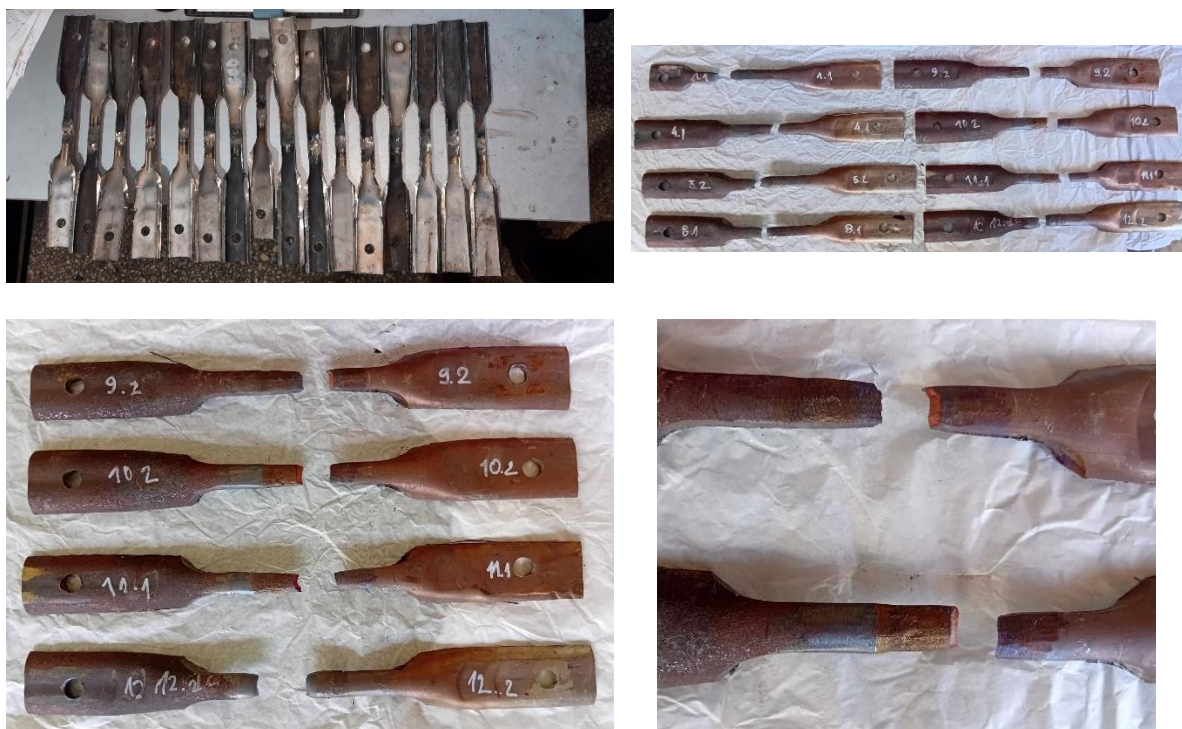
Слика 5.13 Епрувети за испитување со краткотрајно оптоварување на високи температури и лом на заварени проби
