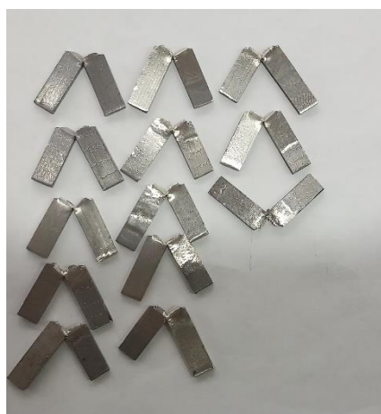
Слика 5.16 Уред и епрувети за испитување на жилавост и лом на епрувети
