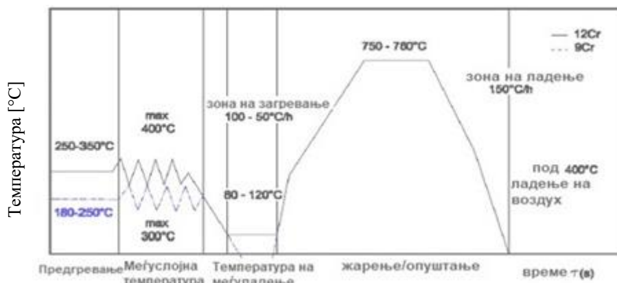
Слика 3.5 Споредба на термички циклус помеѓу 12% и 9% на хром челици
