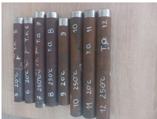
Слика 5.2 Обложување на мартензитен челик
