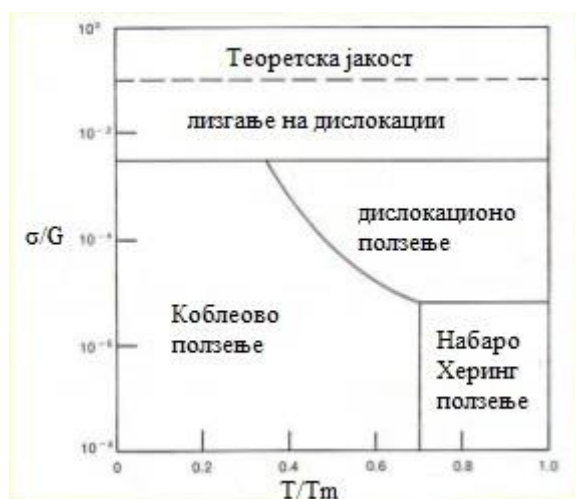
Слика 3.6 Механизми на ползење при високи температури
