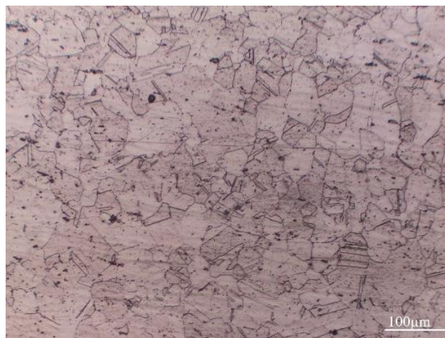
Слика 4.4 Микроструктура на стабилизирани нерѓосувачки челик (x100)
