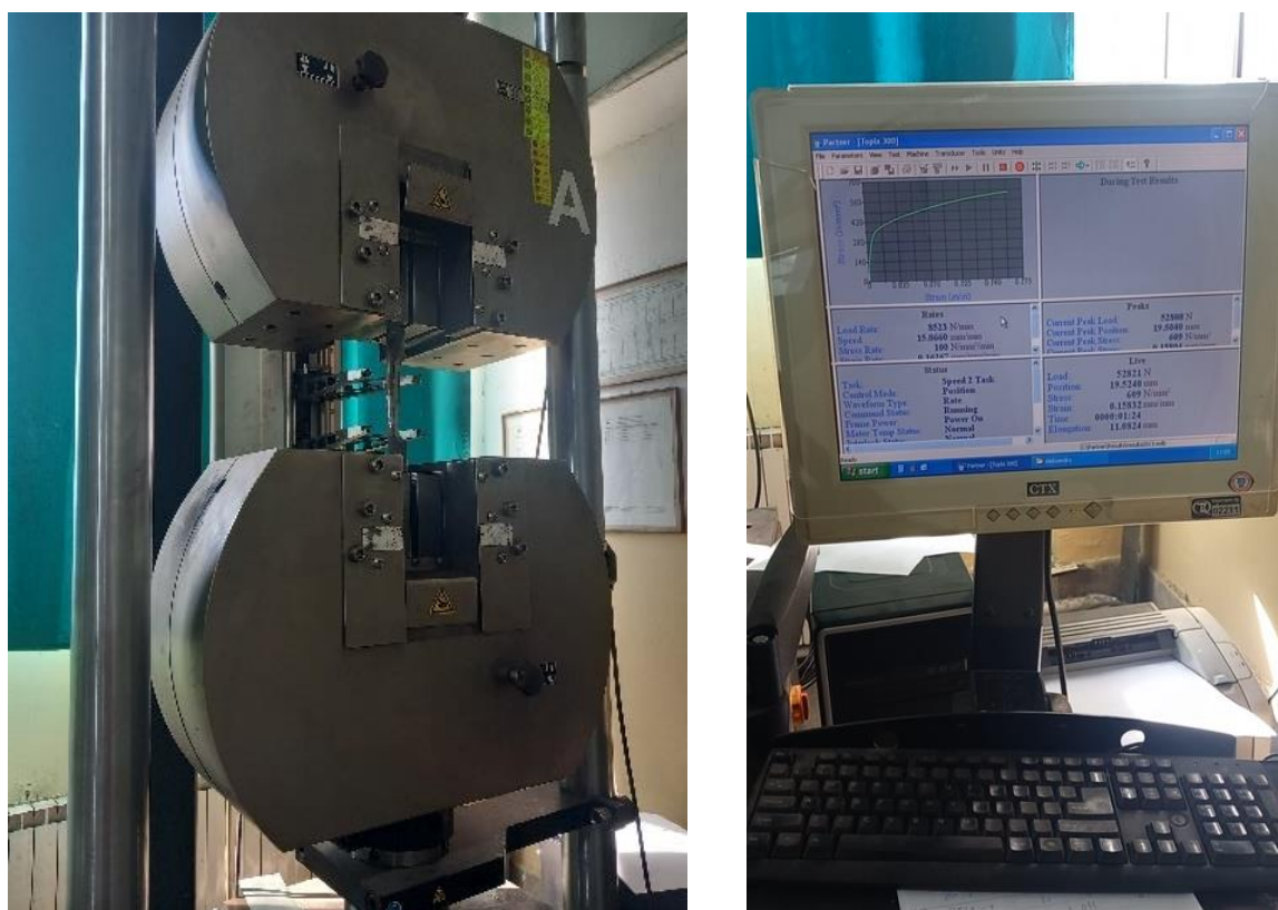
Слика 5.9 Аксијална машина за испитување на затегнување Instron 600LX
