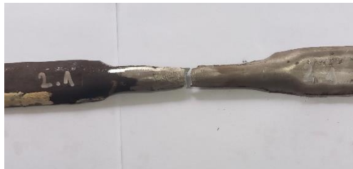
Слика 5.10 Епрувети и лом на епрувети при испитување на затегнување
