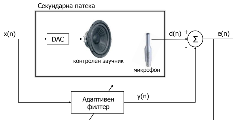
Слика 5-4: Блок-дијаграм на моделирање на секундарната патека
