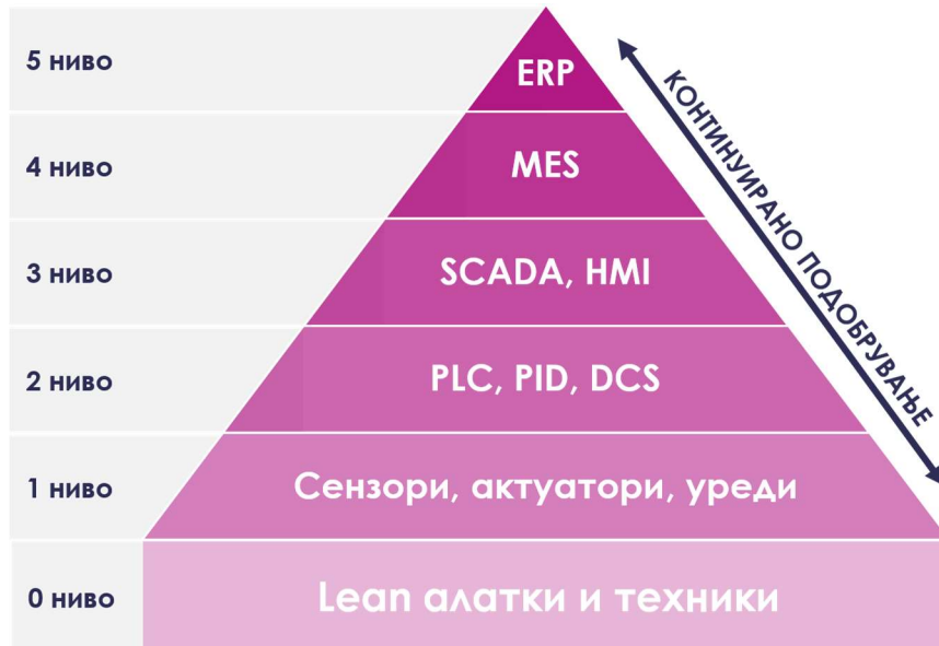
Слика 3.13 Трансформација на архитектурата на системите на Индустија 4.0
