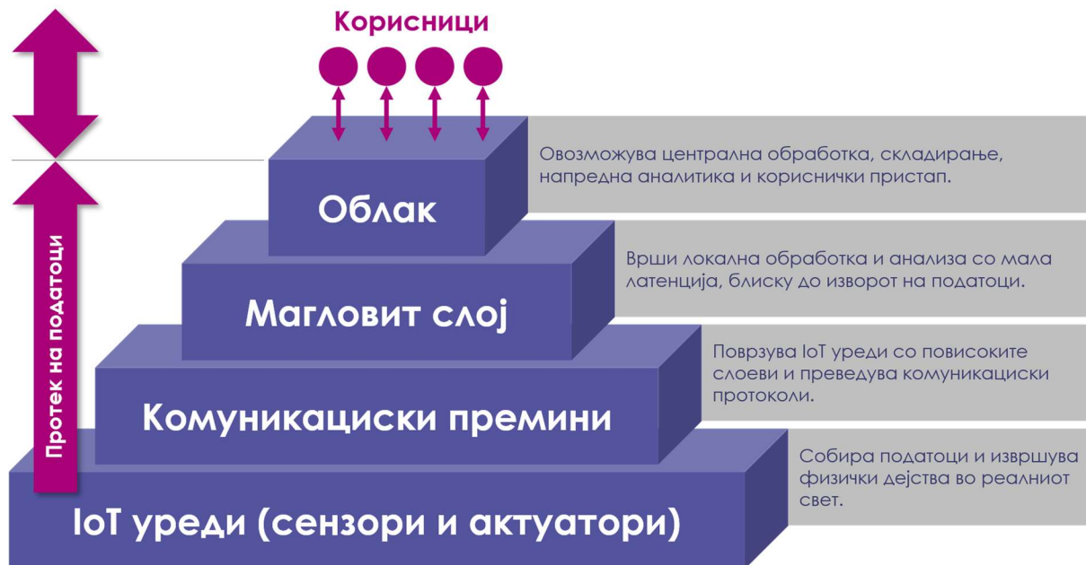
Слика 2.7 Рамка на функционирање на интернет на нештата
