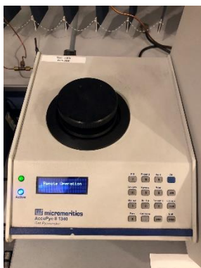
Слика 4.1. Гасен пикнометар Micromeritics AccuPyc II 1340
