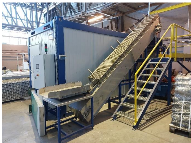
Слика 4.20. Инсталација за подготовка на отпад (вага и транспортна лента)
