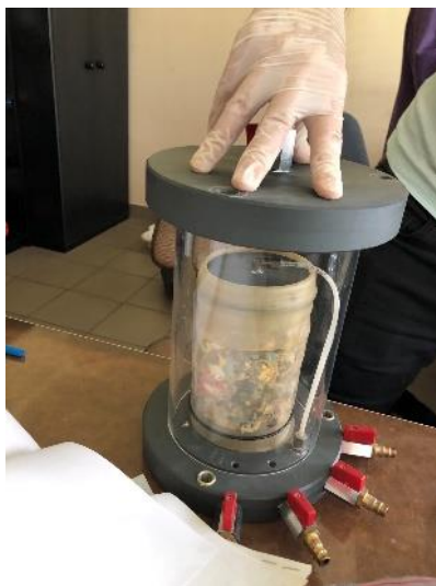
Слика 4.28. Компактиран отпад внесен во притисна комора
