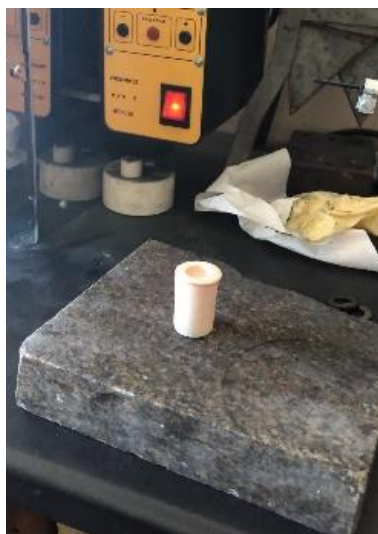
Слика 4.33. Загреан сад со отпад по вадење од печката
