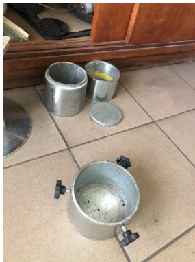
Слика 4.6. Елементи на компакторот – цилиндар
