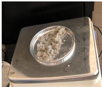
Слика 4.13. Сад користен за мерење и сушење на примероците
