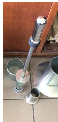
Слика 4.7. Елементи на компакторот – чекан
