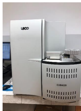
Слика 4.15. LECO Truspec CHN 628 анализатор на јаглерод, водород и азот
