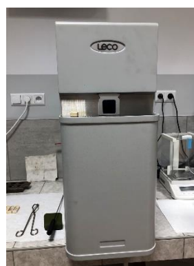
Слика 4.16. LECO S832 анализатор на сулфур
