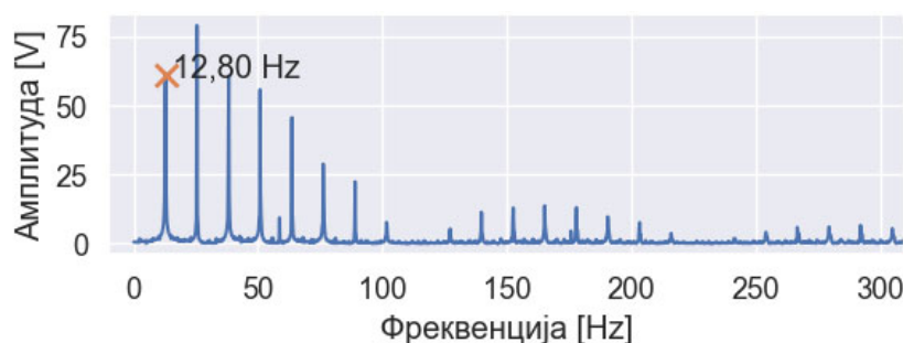
Слика 10. Измерен сигнал од тахометар во фреквентен домен
