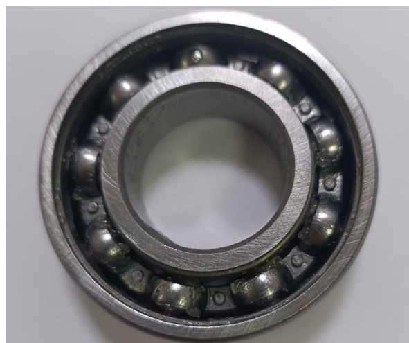
Слика 62. Оштетено тркалачко лежиште со локални дефекти на кафез и топче
